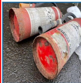
表面に大きな傷や変形箇所のある消火器、底が錆びた消火器は、大変危険ですので、絶対に使用しないでください。
