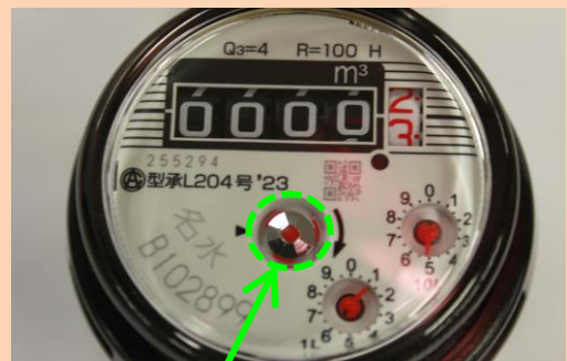
パイロット (水が出ていると回転する)
