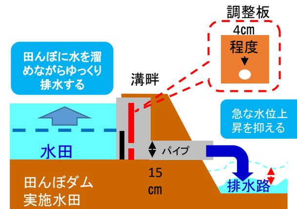
小さな穴の開いた板等を取り付け、ゆっくりと排水を流すことで、排水路の急激な水位の上昇を防ぎます。
