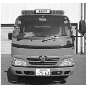
▲消防団に配備されている小型動力ポンプ付積載車
