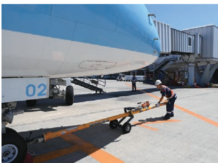
航空機を牽引するための装置を取り付ける手塚さん。すべての作業に正確さが求められます
